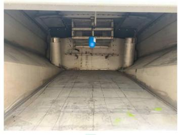
17) 垃圾箱采用 3mm 不锈钢材质,可以防止一般性腐蚀,延长使用寿命。
