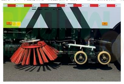
3)采用先进的 CAN 总线、智能化一键控制技术,全部作业均在驾驶室内完成,作业时,只需选定作业模式后,各作业机构的启动与关停由程序自动控制。具有全洗扫作业、左洗扫作业、右洗扫作业、全扫路作业、左扫路作业、右扫路作业、全吸作业、左洗作业和右洗作业等 9 种作业模式可选。
