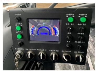
4) 在一键控制技术基础上增加副发动机手动油门控制系统,可根据路况独立调节油门大小,
