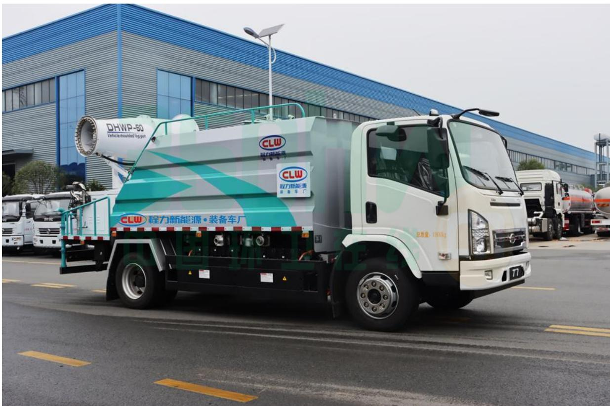
工作原理：采用自吸式双级离心泵，效率高、洒水宽度大、水枪射程远，低压水泵由底盘变速器取力器通过传动轴直接传动。雾炮机组由底盘电池带动雾炮风扇电机、不锈钢多级离心泵，进行喷雾降尘工作。
